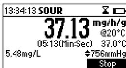
Caso o valor SOUR seja corrigido para 20 °C (68 °F) e a unidade de temperatura não se encontrar na gama de 10 a 30 °C, o valor de temperatura fica a intermitente para alertar que a correção de temperatura não é válida.
