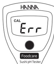
Em modo de calibração, se o medidor apresentar uma mensagem "Err" quando estiver na solução padrão correta, a sonda tem de ser limpa. Coloque a sonda na solução de limpeza HI700641 durante 20 minutos. Enxague com água purificada e volte a colocá-la na solução de armazenamento durante 30 minutos antes de realizar a calibração.
