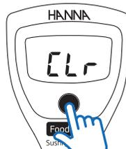
Coloque o medidor em modo de calibração. Prima e mantenha ON/OFF até ser indicado "CLr". O medidor estará agora na calibração predefinida. Não são indicados símbolos no modo de medição até que seja realizada a calibração.
