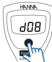
Enquanto em modo de medição, prima e mantenha pressionada a tecla ON/OFF. O medidor passa por "OFF", "CAL" e depois a atual definição de auto-off.
