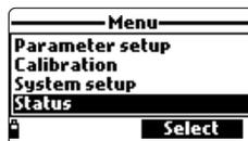
Selecione “Status do Medidor” para exibir as informações do medidor sobre bateria, armazenamento, temperatura interna, senha, ID do medidor, número de série e versão do firmware.
