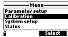
O método de calibração rápida fornece uma rápida calibração de um ponto para sensores de pH, condutividade e oxigênio dissolvido. A solução de calibração **HI9828-0** é usada tanto para a calibração de pH e condutividade.
